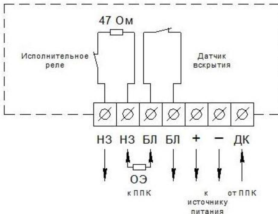
Рисунок 3.3 - Колодка извещателя для внешних подключений
