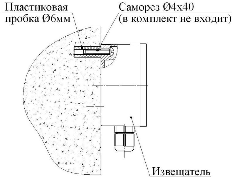
Рисунок 3.2 - Крепление извещателя
